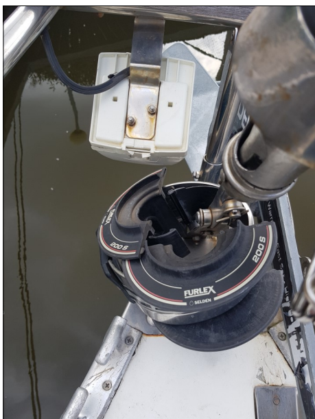
Die zerstörte Reffanlage des Fock
